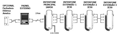
Para não ter toque em qualquer extensão (um ponto ou mais), basta não interligar o terminal "2". Para diminuir o volume do toque, basta cortar o resistor 31 do circuito, conforme indicado na figura abaixo.
